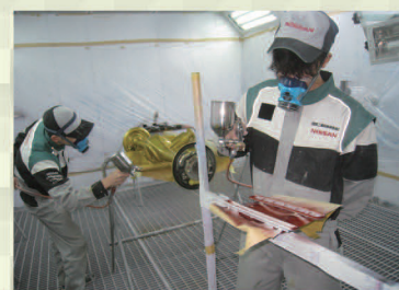
④リヤアクスルと、内装部品の塗装作業
