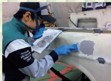
①サイドボデー修復作業
